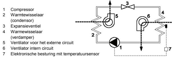
De koelvloeistof wordt door de compressor (1) sterk verdicht. Dit laat de temperatuur stijgen. In de condensor (2) wordt de opgewekte warmte aan de omgevingslucht afgegeven. Het koelmiddel gaat daarbij over in de vloeibare fase. De ventilator voor de condenser (5) zuigt de omgevingslucht door de condensor en blaast de opgewarmde lucht in de open ruimte.
