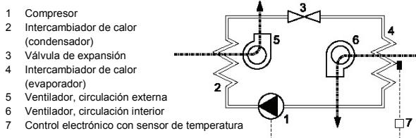
El compresor (1) comprime el refrigerante a una presión elevada. Durante este proceso se eleva la temperatura. En el condensador (2) se disipa el calor al aire ambiente y el refrigerante se condensa, pasando a líquido. El ventilador del condensador (5) coge aire del ambiente a través del condensador, y después expulsa el aire.
