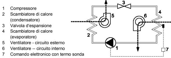
I refrigerante è compresso ad una pressione elevata dal compressore (1). In questo modo la temperatura sale. Nel condensatore (2) il calore è assorbito dall'aria ambiente ed è passato attraverso il refrigerante. Il ventilatore soffiante del condensatore (5) aspira l'aria attraverso il condensatore e le espelle nell'ambiente.
