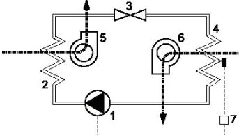
Le fluide frigorigène est comprimé par le compresseur (1) à une haute pression. Lors de ce procédé, la température monte. Dans le condenseur (2) la chaleur est refoulée dans l'air ambiant, ce qui fait que le fluide frigorigène se liquéfie. Le ventilateur du condenseur (5) aspire l'air ambiant par le condenseur et refoule cet air vers l'extérieur.
