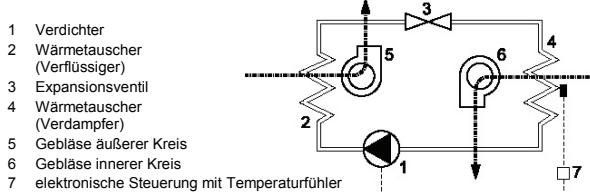
Das Kältemittel wird durch den Kompressor (1) auf einen hohen Druck verdichtet. Dabei steigt die Temperatur an. Im Verflüssiger (2) wird die Wärme an die Umgebungsluft abgegeben, dabei verflüssigt sich das Kältemittel. Das Verflüssigergebläse (5) saugt die Raumluft durch den Verflüssiger und gibt sie wieder an die Umgebung ab.
