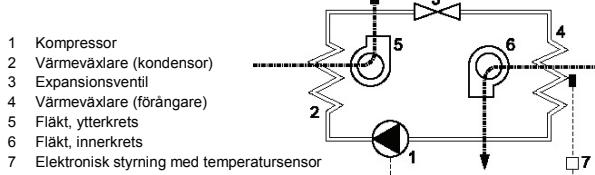
Kylmediet komprimeras till högt tryck av kompressorn (1). Därvid ökar temperaturen. I kondensatoren (2) avges värmen till den omgivande luften och därvid återgår kylmediet till vätskeform. Kondensatorfläkten (5) suger rumsluftens genom kondensatoren och avger den till omgivningen.
